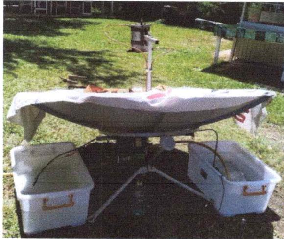
Gambar L.1.6 Uji Kinerja PCM Menggunakan Kolektor Surya pada Kondisi Disharging
