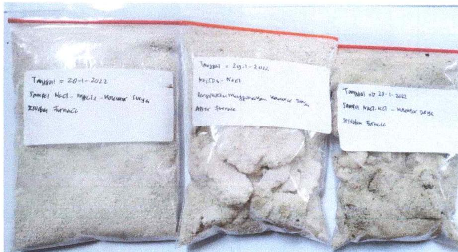
Gambar L.1.7 Produk garam eutektik setelah uji kinerja PCM dengan kolektor surya
